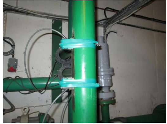
Figur 25: ultraljudflödesmätning på vatten rör (trycksida och kylvatten).
